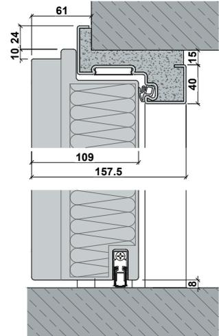
› **Vertikalschnitt C - C**
